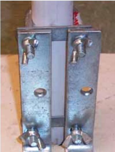
当你在用 L 托架的时候，要用上面和下面的孔（不要用中间的），那样放进去天线杆会直立，会被 U 形螺拴紧紧固定。到这个时候你可以试着去确认天线杆是否处在合适的位置
