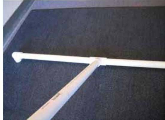
把四个 L 形的连接器安在之前你制作的基座的顶端开口处。现在你的天线可以直立的站起来了。
