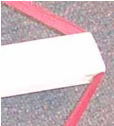
为了把电线缠到天线框架上，用一把圆木挫把十字架的四个末端做成 U 形凹槽，大约 1.2cm 深。凹槽两端边缘应该被做成斜边，使锋利的角变钝，以及防止天线受损破裂。
