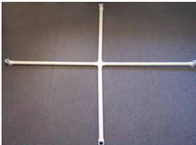
旋转顶端的连接器，使连接器的开口处垂直于十字轴（如图）。这是完成的框架。你可以接着这个设计做下去，像我们一样弄一个“脚形的支撑”，或把它固定到一个天线杆。天线杆的设计模型可以在附录 E 中找到或在网页：
