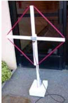
SID 天线称作“**线圈天线**”，它仅仅是一个框架支撑着“缠绕”的或环形的线。这里没有 SID 检测器天线的标准大小，甚至形状上也没有标准要求。天线并不需要有精确的尺度规格上的统一，也不需要相同的电线圈数，也不必建得和这篇文章中类似甚至一模一样。鼓励读者根据自己可以容易的材料来实验和调整自己的天线。
